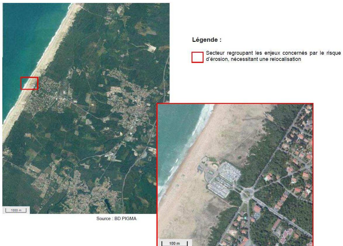
Figure 43 : Secteur de la commune de Labenne regroupant les enjeux concernés par le risque d'érosion
