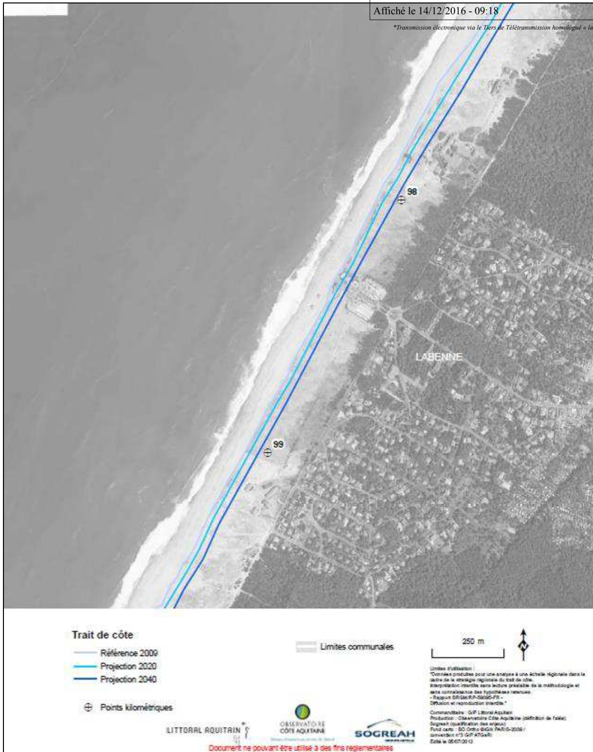
Figure 38 : Projections du recul du trait de côte à Labenne Océan aux horizons 2020 et 2040
