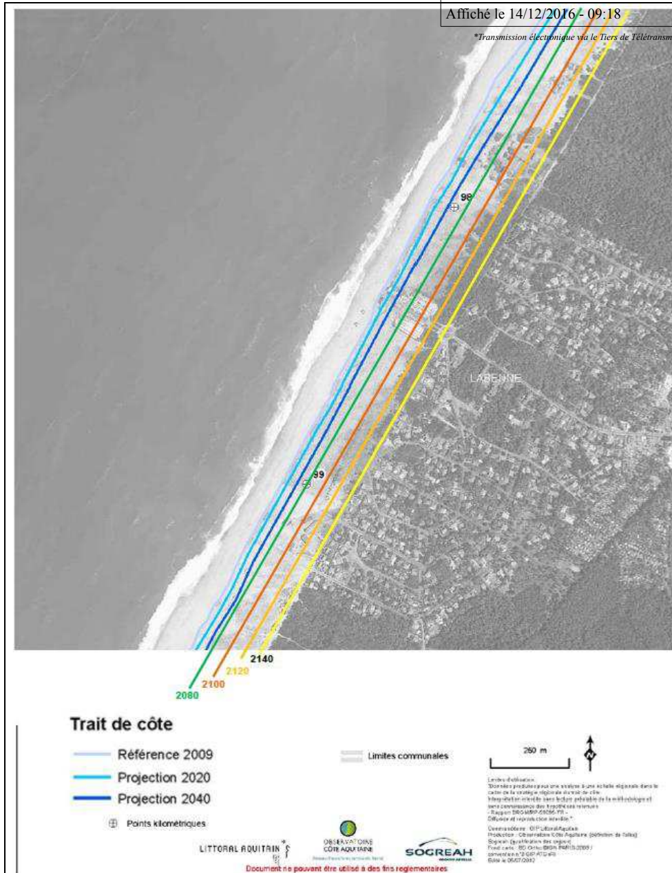
Figure 44 : Approximation de la position du trait de côte en 2100 à Labenne Océan
