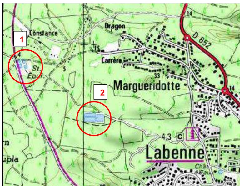
La station d'épuration est en service depuis 2000. Elle a une capacité de 20 000 équivalents habitants. L'effluent épuré est infiltré par le sable dunaire dans le site d'infiltration. Les boues sont traitées par compostage sur la plateforme d'un site.
