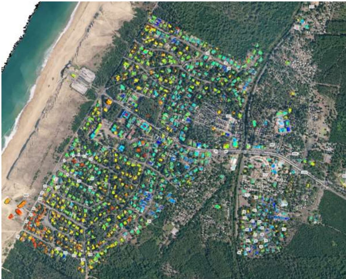
Figure 43 : Thermographie aérienne sur Labenne-Océan
