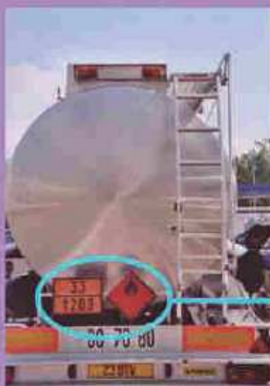
Signalisation d'un TMD (© Alp Géorisques)
