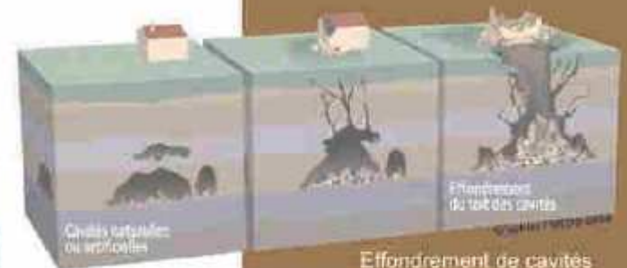
Effondrement de cavités souterraines
